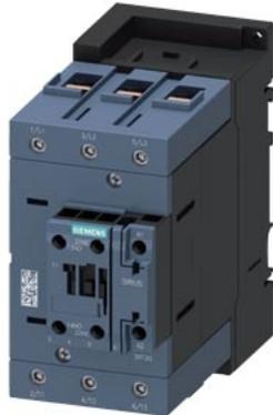
Contacteur, 1 CA, 160 A/690 V/40 °C, S3, 3 pôles, 24V CA/50Hz, 1 NO +1 NF, borne à cage/borne à vis
