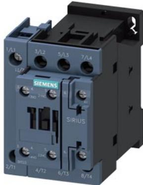
Contacteur, 1 CA, 50 A/400 V/40 °C, S0, 4 pôles, 110V CA/50Hz, 120V/60Hz, 1 NO +1 NF, borne à vis
