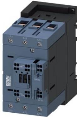
Contacteur de puissance, AC-3 : 110 A, 55kW / 400V 1 NO + 1 NF, 20-33 V CA/CC communicant 3 pôles, 3S, taille S3 borne à ressort varistance intégrée
