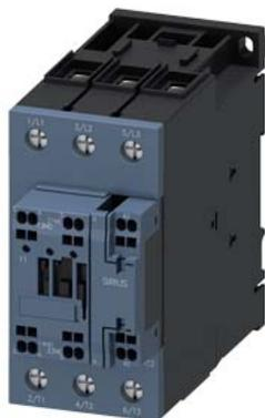
contacteur de puissance, AC-3 51 A, 22 kW / 400 V 1 NO + 1 NF, 20-33 V CA / CC communicant, avec varistance, 3 pôles, taille S2, borne à ressort
