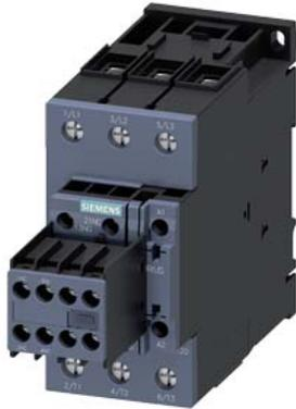
contacteur de puissance, AC-3 51 A, 22 kW / 400 V 2 NO + 2 NF, 100V CA
