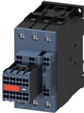
Contacteur de puissance, AC-3 : 40A, 18,5 kW / 400 V 2 NO + 2 NF, CA / CC 20-33 V, commu- nicant, avec varistance, 3 pôles, taille S2, Bornes à ressort, Interrupteur auxiliaire non amovible
