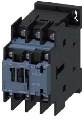
Contacteur de puissance, AC-3 38 A, 18,5 kW / 400 V 1 NO + 1 NF, 460 V CA 60 Hz, 3 pôles, taille S0 Connexion par cosse à œillet
