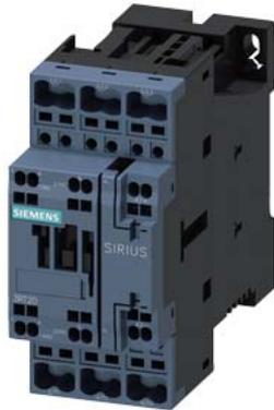
contacteur ferroviaire, AC-3e/AC-3, 38 A, 18,5 kW / 400 V, 3 pôles, 36 V DC, 0,7-1,25\* US, mécanisme de commande électronique avec varistance intégrée, contacts auxiliaires : 1 NO + 1 NF, borne à ressort, taille : S0
