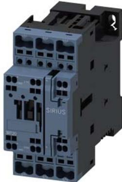
Contacteur de puissance, AC-3 38 A, 18,5 kW / 400 V 1 NO + 1 NF, 24V CC communicant, 3 pôles, Taille S0, bornes à ressort
