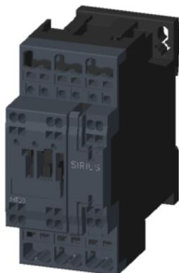
Contacteur de puissance, AC-3 38 A, 18,5 kW / 400 V 1 NO + 1 NF, 24V CA 50 Hz, 3 pôles, taille S0 borne à ressort
