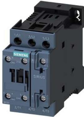
Contacteur de puissance, AC-3 32 A, 15 kW / 400 V 1 NO + 1 NF, CA 50-60 Hz / CC 200-280 V CA / CC 3 pôles, taille S0 borne à vis
