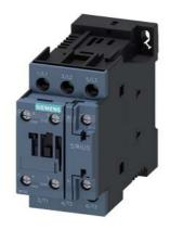
Contacteur de puissance, AC-3 : 12 A, 5,5 kW / 400 V 1 NO + 1 NF, CA (50-60 Hz) circuit de commande DC 95-130 V CA / CC, 3 pôles Taille S0, borne à vis
