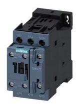
Contacteur de puissance, AC-3 : 9 A, 4 kW / 400 V 1 NO + 1 NF, DC 48 V 3 pôles, Taille S0 borne à vis
