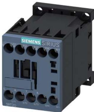
contacteur ferroviaire, AC-3e/AC-3, 12 A, 5,5 kW / 400 V, 3 pôles, 24-34 V DC, 0,7-1,25\* US, mécanisme de commande électronique avec varistance intégrée, contacts auxiliaires : 1 NF, borne à vis, taille : S00
