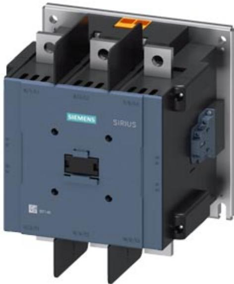
Contacteur de puissance, AC-1 900A, 3 pôles CA (50...60 Hz) / commande CC 200...240 V CA / 200...220 V CC Entraînement: électronique Contacts auxiliaires 2 NO + 2 NF Raccordement par barres Interrupteurs auxiliaires et bornes de bobine dans bornes à vis
