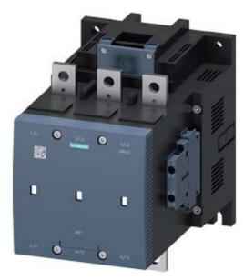
Contacteur sous vide, AC-3 500A, 250kW / 400V CA (50-60 Hz) / commande DC UC 240-277V contacts auxiliaires 2 NO + 2 NC 3 pôles, taille S12 Raccordement par barres Entraînement: conventionnel
