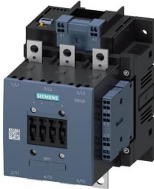
contacteur de puissance, AC-3e/AC-3 185 A, 90 kW / 400 V Uc : DC 110 V x (0,7-1,25) entrée API 24-110 V DC 3 pôles, contacts auxiliaires 2 NO + 2 NF
