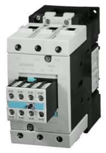
Contacteur de puissance, AC-3 80 A, 37 kW / 400 V 24 V CA, 50 Hz, 2 NO + 2 NF 3 pôles, taille S3 borne à vis !!! Produit en fin de vie !! Le successeur est SIRIUS 3RT2 Successeur préféré : >>3RT2038-1AB04<<
