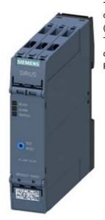
Relais de protection moteur par thermistances Appareil d'avertissement et de coupure Boîtier de 22,5 mm borne à vis 1 NO + 1 INV US = 24V-240V CA/CC Réarmement à distance/manuel/automatique avec homologation ATEX 3 LED (READY/WARNING/TRIPPED) séparation galvanique de sécurité Touche Test / RESET Surveillance de rupture de fil Surveillance de court-circuit insensible aux coupures de tension 2 circuits de sonde PTC séparés
