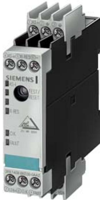
Module de protection contre les défauts à la terre AS-i IP20 S22,5, surveillance des défauts à la terre 1 entrée, Remote Reset 2 x sorties de signalisation, relais DC-12 1 A / DC-13 500 mA (24V) Bornes à vis largeur 22,5mm aucune adresse AS-i nécessaire uniquement surveillance d'AS-Interface
