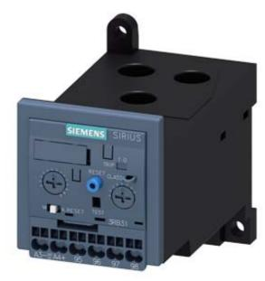
Relais de surcharge 20...80 A électronique pour protection des moteurs Taille S2, CLASS 5E...30E Installation séparée circuit principal : Transformateur à primaire traversant Circuit auxiliaire : bornes à ressort Réarment automatique/manuel Détection interne des défauts à la terre
