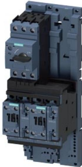
Départ-moteur sans fusibles, inversion de marche CA 400 V, Taille S0 10,0...16,0 A 230 V CA borne à vis pour montage sur rail DIN avec adaptateur pour montage sur rail symétrique (satisfait aussi au type de coordination 1) Type de coordination 2, I<sub>q</sub> = 150 kA 1 contact à fermeture+1 contact à ouverture, (contacteur)
