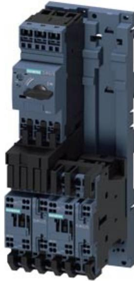
Départ-moteur sans fusibles, inversion de marche CA 400 V, Taille S0 5,50...8,00 A 24 V CC borne à ressort pour montage sur rail DIN avec adaptateur pour montage sur rail symétrique (satisfait aussi au type de coordination 1) Type de coordination 2, I<sub>q</sub> = 150 kA 1 contact à fermeture+1 contact à ouverture, (contacteur)
