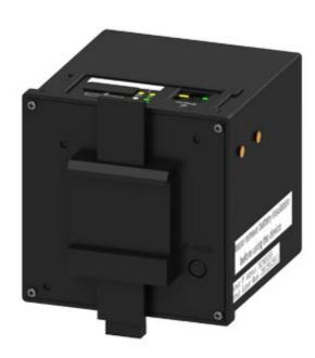
SENTRON, instrumento de medida y registrador de la calidad de la energía, 7KM PAC5200, caja para perfil DIN sin display, L-L: 690 V, L-N: 400 V, 10 A, equipo para perfil DIN, 3- fases, Modbus TCP, energía aparente/ activa/reactiva/cos phi, armónicos: 2.º- 40.º, THD, clase 0,5 según IEC61557-12 o bien clase 0,5S según IEC62053-22, fuente de alimentación universal, AC/DC, borne de tornillo
