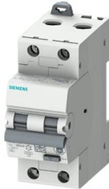
interruptor dif./aut., 6 kA, 2P tipo A, 30 mA, curva B, In: 16 A Un: 230 V
