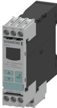
Relé de vigilancia digital vigilancia de tensión, 22,5 mm de 10 a 600V AC/DC Rebase por exceso y rebase por defecto tensión de alimentación: AC/DC 24 V DC y AC 50 a 60Hz sin aislamiento galvánico respecto al circuito de medida retardo de picos perturbadores 0,1 a 20 s Histéresis 0,1 a 300 V 1 conmutado con o sin memoria de fallos borne de tornillo Producto sucesor de 3UG3532-1AC..
