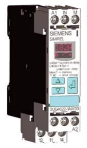
Relé de vigilancia digital vigilancia de corriente, 22,5 mm de 0,05-10 A AC/DC Rebase por exceso y rebase por defecto AC/DC 24 hasta 240 V DC y AC 50 a 60Hz Retardo de arranque y retardo de picos perturbadores 0,1 a 20 s Histéresis 0,01 a 5 A 1 conmutado con o sin memoria de fallos borne de tornillo Producto sucesor de 3UG3522-1AL20, 3UG3522-1AG20 y 3UG3522-1AC48-0AA1
