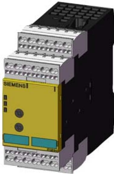
Módulo de seguridad SIRIUS de seguridad vigilancia de parada DC 24 V, 45 mm borne de resorte FK instantáneo: 3 NA + 1 NC FK retardado: 0 MK: 3 arranque automático aparato base cat. de fallo máx. EN 954-1: 4 PL máximo alcanzable según EN 13849-1: redondos SIL máximo alcanzable según IEC 61508: 3
