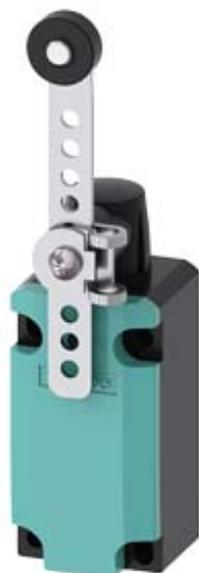
interruptor de posición Caja de plástico de 40 mm Palanca de rodillo de longitud ajustable Palanca metálica con taladros en retícula rodillo de plástico de 19 mm según DIN EN 50041 Conexión del aparato 1x (M20 x 1,5) 1NA/2NC contactos de acción brusca Actuador de fracción de vuelta derecha/izquierda regulable
