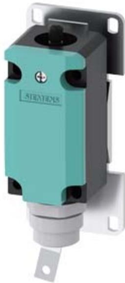
cuerpo para interruptor de posición 3SE51 caja metálica 40 mm según DIN EN 50041 con conector 6+PE (3SY3131) según EN 43651, 1NA/1NC contactos de acción brusca Asignación de pines: Pin1=21, Pin2=22 pin3=13, Pin4=14 PIN5 Y PIN6 no conectado PE conectado con dispositivo de cambio rápido 3SY3110 + 3SY3027 conector hembra aéreo correspondiente 3SY3126
