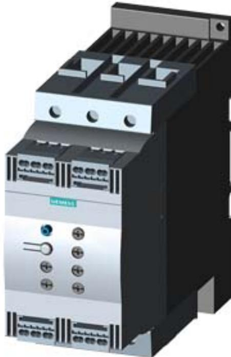
arrancador suave SIRIUS S3 106 A, 75 kW/500 V, 40 °C AC 400-600 V, AC/DC 24 V bornes de resorte relé de protección de motor por termistor
