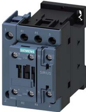
Contactor de potencia, AC-3 25 A, 11 kW/400 V 2 NA + 2 NC 24 V AC, 50 Hz 4 polos tamaño S0 conexión por tornillo 1 NA + 1 NC integrados
