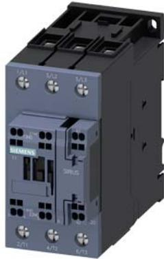
Contactor de potencia, AC-3 40 A, 18,5 kW/400 V 1 NA + 1 NC, 48 V AC 50 Hz, 3 polos, tamaño S2, conexión por resorte
