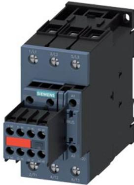
contactor de acoplamiento, AC-3 40 A, 18,5 kW / 400 V 2 NA + 2 NC, 24 V DC con varistor, tripolar, tamaño S2, borne de tornillo bloque de contactos auxiliares no desmontable adecuado para salidas PLC de 2 A
