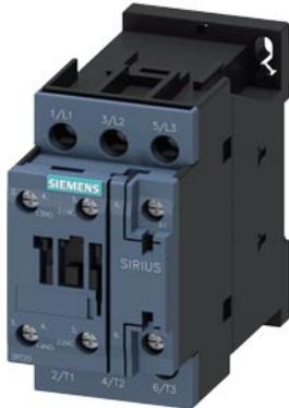
contactor, AC-3, 18,5 kW / 400 V, 1 NA + 1 NC, AC 110 V, 50 Hz, 3 polos, Tamaño S0 borne de tornillo
