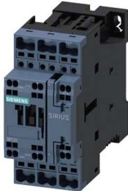
contactor de potencia, AC-3 32 A, 15 kW/400 V 1 NA + 1 NC, 12 V DC con varistor integrado 3 polos, tamaño S0 conexión por resorte apto para salidas PLC no con contacto auxiliar ampliable
