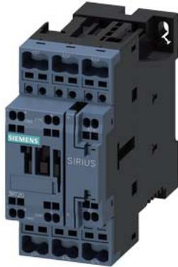
Contactor de potencia, AC-3 25 A, 11 kW/400 V 1 NA + 1 NC, AC (50-60 Hz) mando por DC 200-280 V AC/DC, 3 polos, tamaño S0, conexión por resorte
