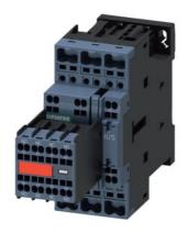
Contactor de potencia, AC-3 25 A, 11 kW/400 V 2 NA + 2 NC, 230 V AC 50/60 Hz, con varistor insertado, 3 polos, tamaño S0 conexión por resorte bloque de contactos auxiliares no desmontable
