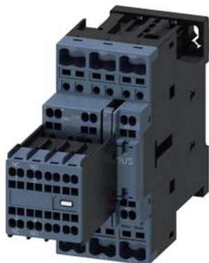
Contactor de potencia, AC-3 12 A, 5,5 kW/400 V 2 NA + 2 NC, 230 V AC 50/60 Hz, 3 polos tamaño S0, conexión por resorte Bloque de contactos auxiliares desmontable
