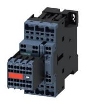
Contactor de potencia, AC-3 9 A, 4 kW/400 V 2 NA + 2 NC, 24 V DC con combinación de diodos insertada, 3 polos, tamaño S0, conexión por resorte bloque de contactos auxiliares no desmontable
