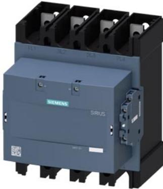
Contactor, AC-1, 525 A/400 V/40 °C, S12, 4 polos, 24-60 V AC, 20-60 V DC, 2 NA+2 NC, pletina de conexión/ borne de tornillo
