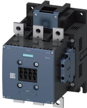
contactor de potencia, AC-3 300 A, 160 kW/400 V AC (50-60 Hz)/mando por corriente continua 110-127 V AC/DC contactos auxiliares 2 NA + 2 NC tripolar, tamaño S10 conexiones de barras accionamiento: convencional borne de tornillo versión NEMA
