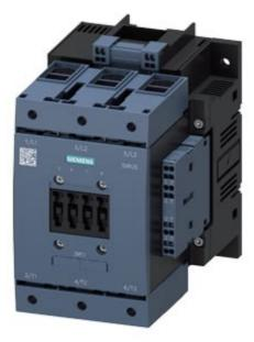
Contactor de potencia, AC-3 115 A, 55 kW/400 V AC (50-60 Hz)/mando por DC 42-48 V UC Bloque de contactos auxiliares 2 NA + 2 NC 3 polos, tamaño S6 con bornes tipo marco accionamiento: convencional conexión por resorte
