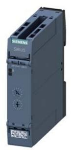
relé temporizador, electrónico retardado a desexcitación sin señal de control o ejecución segura con paso momentáneo a conexión no volátil 7 rangos de tiempo 0,05...600 s AC/DC 24 V, 2 conmutados con LED, borne de resorte (inserción rápida)
