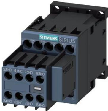
contactor auxiliar, 5 NA + 3 NC, AC 48 V, 50 / 60 Hz, Tamaño S00, bornes de tornillo, 2 NA + 2 NC unidad base / DIN EN frontales enchufados
