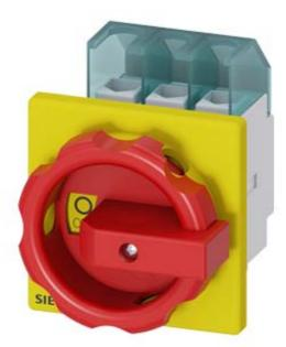
SENTRON, interruptor-seccionador 3LD, Pulsador de parada de emergencia, 3 polos, lu: 25 A, Potencia de empleo / con AC-23 A a 400 V: 9,5 kW, con fijación frontal, Accionamiento giratorio, rojo/amarillo, Fijación por 4 taladros de la maneta
