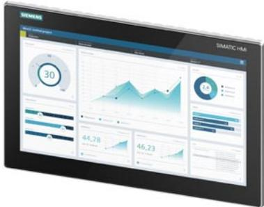
SIMATIC HMI MTP1500, Unified Comfort Panel, Touchbedienung, 15,6" Widescreen-TFT-Display, 16 MIO Farben, PROFINET Schnittstelle, projektierbar ab WinCC Unified Comfort V16, enthält Open Source SW, die unentgeltlich überlassen wird siehe beiliegende DVD
