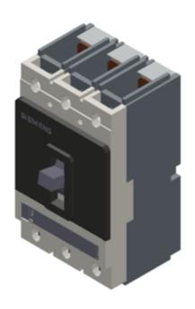
Leistungsschalter VL250N Standardschaltvermögen Icu=55kA, 415V AC 3-polig, Anlagenschutz Überstromauslöser ETU10, LI In=200A, Bemessungsstrom IR=80...200A, Überlastschutz, II=1,25 bis 11 xIN, Kurzschlussschutz ohne Hilfsauslöser ETU kommunikationsfähig ohne Hilfs-/Alarmschalter
