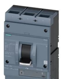
Leistungsschalter 3VA2 IEC Frame 1000 Schaltvermögenklasse C Icu=110kA @ 415V 3-polig, Anlagenschutz ETU340, ELISA LI, In=1000A Überlastschutz Ir=400A...1000A Kurzschlussschutz Ii=10 x In Schraubenflachanschluss
