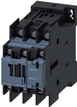
Leistungsschütz, AC-3 17 A, 7,5 kW / 400 V 1 S + 1 Ö, DC 24 V mit integriertem Varistor 3-polig, Baugröße S0, Ringkabelschuhanschluss geeignet für SPS-Ausgänge nicht mit Hilfsschalter erweiterbar
